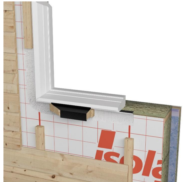
Fig. 9 Tetting rundt vinduer på utsiden av vindsperren ved bruk av Isola FlexTett 100 Vindus Rims Figur: Isola as
