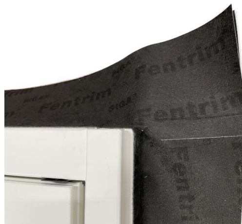
Fig. 3 Eksempel på et vindu for levering med montert tepestrimmel. Ved innsetting av vinduet skal tepestrimmelen klebes mot vindspærren. Figur: Uldal AS
