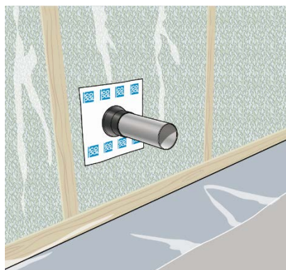
Fig. 5 Icopal Ventex Rørmansjett Vegg benyttes til tetting av rørgjennomføringer i damp- og vindsperrsjiktet.
