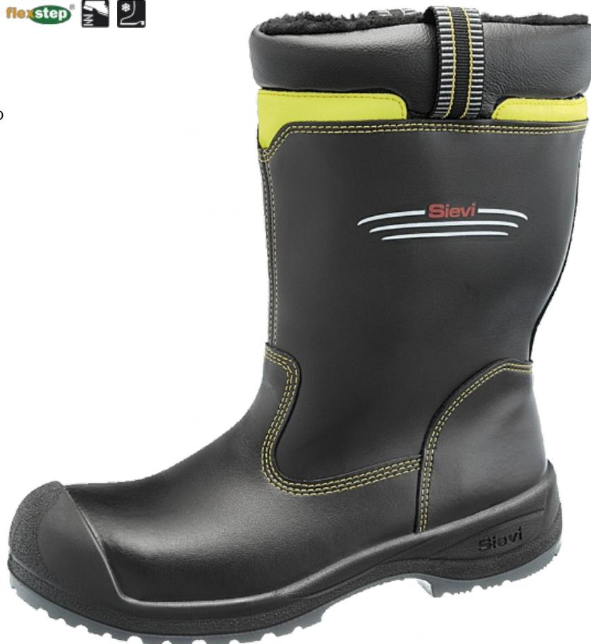
Foten er beskyttet med en tåhette i aluminium og stål spikertramp, samt utvendig PU nese. Overdelen er laget av slitesterkt skinn. Den nydesignede varmebestandige yttersålen er laget av gummi i grå farge, er meget holdbar og varmebestandig opp til 300 °C.
