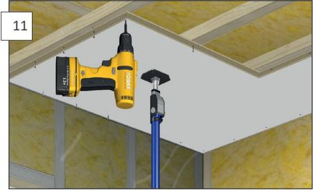
Platerekke nr. 2. Tilskjær første plate i andre platerekke. Platene skal monteres i forband. Lim profilen som klikkes på plass.
