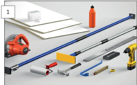
Ha alt du trenger av utstyr klart før monteringen starter. For takflater lengre enn 8m må det legges inn ekstra ekspansjonsklaring, min. 1,5mm pr. lm tak. Premium Ceiling monteres på min. 30mm lekter, eller direkte eksisterende platehimling. NB! Forestia Styreskinne og slagkloss er spesialtilpasset profilen til Premium Ceiling.
