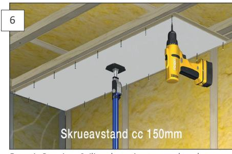
Forestia Premium Ceiling skrues i noten med treskrue. Benytt senkehode 3,0/35mm eller tilsvarende. Skrueavstand cc 150mm. Kramper kan også benyttes. De skal ha rett rygg, min. 10mm bredde og lengden på bøna bør være min. 35mm. NB! Trykk på krampepistol må justeres nøyne. Kramper/skruer skal ikke dykkes, men flukte med overflate i nota.
