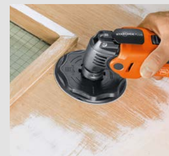
Den store slipedisen erstatter ekstra slipemaskiner som eksenterslipere og vibrasjonsslipere.
