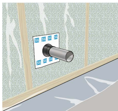
Fig. 5 BMI Rørmansjett benyttes til tetting av rørgjennomføringer i damp- og vindspærresjiktet.
