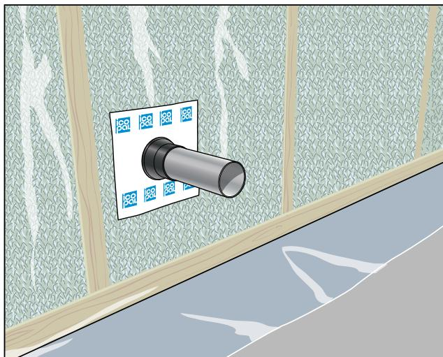
**Icopal Rørmansjett** består av en selvklebende krave med akryllim og en flens av gummi. Mansjetten brukes til tetting av rørgjennomføringen på vindsporre- eller dampspresjiktet. Ved bruk av rørmansjett utvendig må mansjetten tildekkes med en gang den er klebet på vindsporen.
