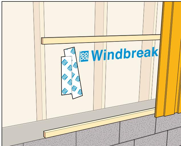
Icopal Universaltape FT gir god lufttetting ved forsegling av rifter i dampsperran eller vindsperran. Klipp til tapebitene så de dekker skadens lengde. Tapebitene skal presses tett til underlaget og overlappes hverandre.
