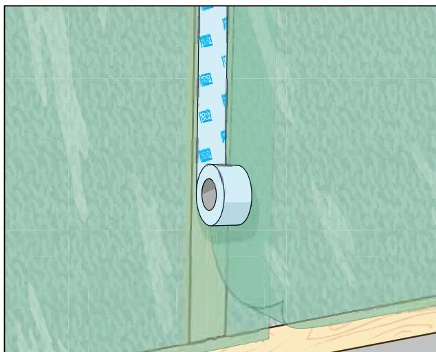
Icopal Universaltape FT brukes til forsegling av skjøter og overganger i vindsperr- eller dampspresjkj.
