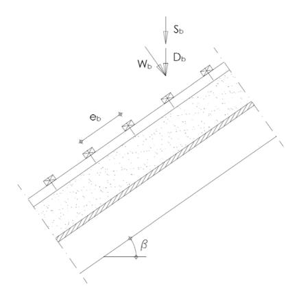
$$\begin{aligned} D_b &= d \cdot e_b \cdot e_r \\ S_b &= s \cdot e_b \cdot e_r \cdot \cos \beta \\ W_b &= w_p \cdot e_b \cdot e_r \end{aligned}$$
