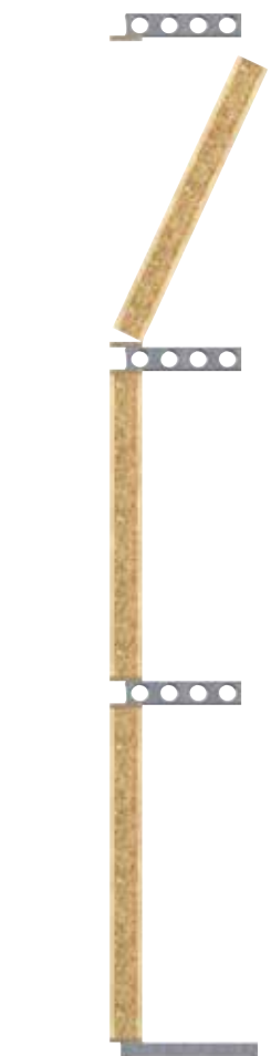
Utfyllende bindingsverk Masonite stender montert tradisjonelt mellom dekkene
