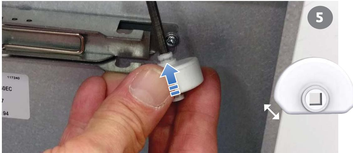
**N** Trekk spjeldet ut, slik at eksenter med vaier kan settes på plass i spjeldet. Nytt spjeld er nå ferdig montert.
